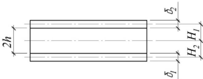
Рис. 7. Схема расположения слоев в двухслойном куполе
