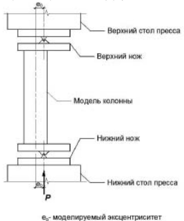
Рис. 2. Схема приложения внецентренной нагрузки на испытательном стенде (вид сбоку)
